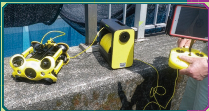
浄水設備(取水口や配水池)のゲートやバルブなどを調査する水中ドローン。適正な更新、修繕計画を立てるための調査を安全かつ効率的に行うことが期待されます。
