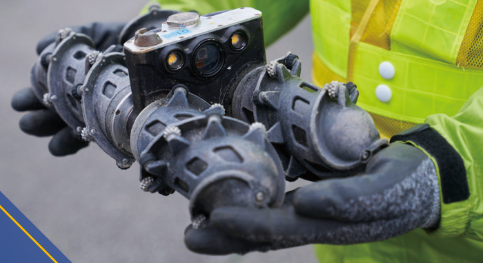
小口径の下水道管路を自動走行で調査する「アルキメデス」。コンパクトで持ち運びやすく、災害時の調査にも活躍できる。
